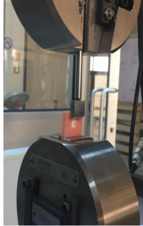
Resim 14: Mikro makaslama bağlantı dayanımı testi
