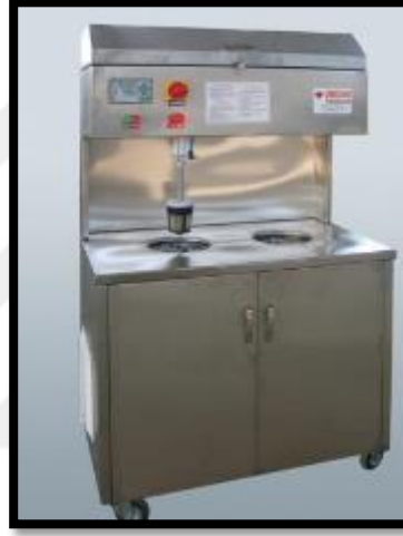
Resim 30: Çalışmada kullanılan termal siklus cihazı (Gökçeler Makina, Türkiye)
