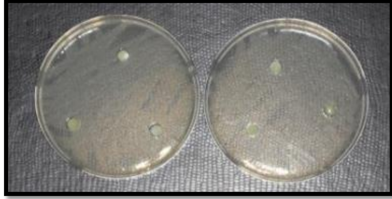
Resim 37: Işık ile polimerizasyon yapılan Peak Universal Bond'un agar difüzyon testine ait görüntüleri
