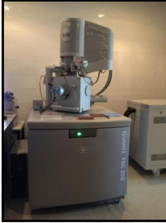
Resim 3-20: Çalışmada kullanılan EDS X-ışını dedektörüne sahip taramalı elektron mikroskobu (Quanta-FEG 250, FEI Company, OR, ABD)
