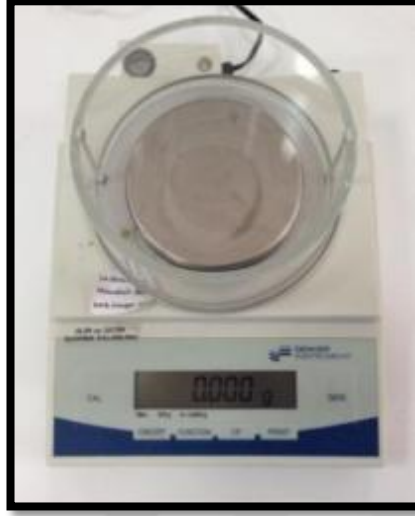
Resim 3-4: Ölçümler için kullanılan hassas terazi (Denver Instruments, New York, ABD)
