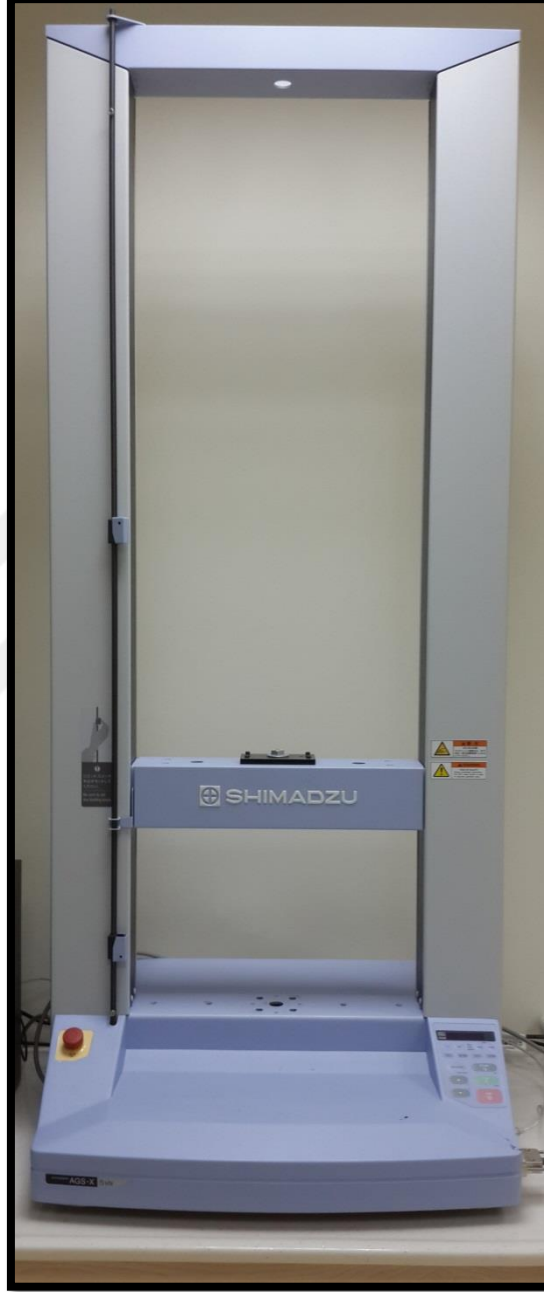
Resim 3-25: Üniversal test cihazı (Shimadzu, Model AGS-X 5kN, Shimadzu Corporation, Kyoto, Japonya)
