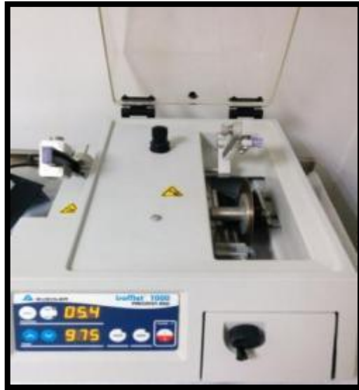
Resim 3-8: Hassas kesme cihazı (Buehler Inc., Lake, Bluff, IL, ABD)
