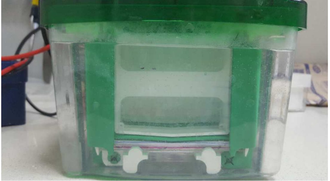
Resim 3: WB yönteminde jel elektroforezinde antijenlerin ayrıştırılması
