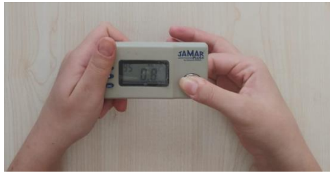
Şekil 13. Parmak Ucu Kavrama Gücünün Pinç metre ile Değerlendirilmesi
