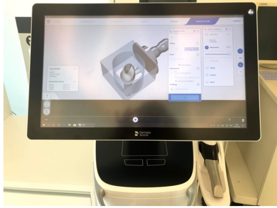
Resim 1: Dayanakların CAD/CAM cihazında tasarımlarının yapılması
