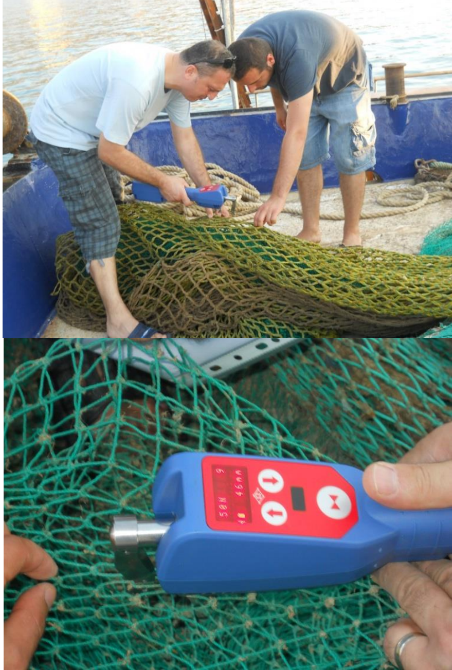
Şekil 3.4: Omega Mesh Gauge cihazı ile ağ gözlerinin ölçümü.
