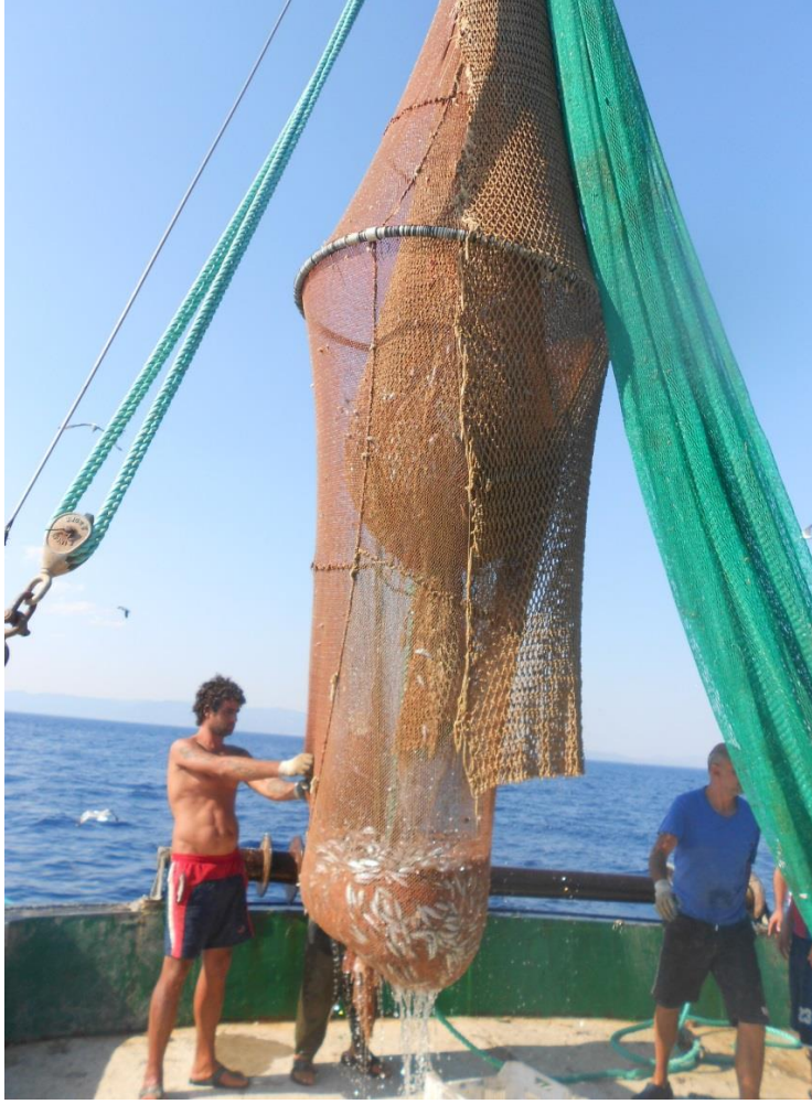
Şekil 3.5: Torba seçiciliğini ölçmede kullanılan çemberli örtü torba.
