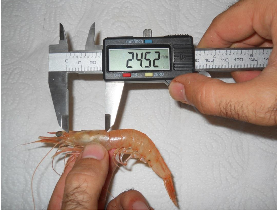
Şekil 3.7: Dijital kumpas ile karideslerin karapas boyu ölçümü.
