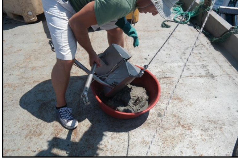
Şekil 2.3.3: Van Veen Grab yardımıya istasyonlardan alınan sediment örnekleri (Orijinal).
