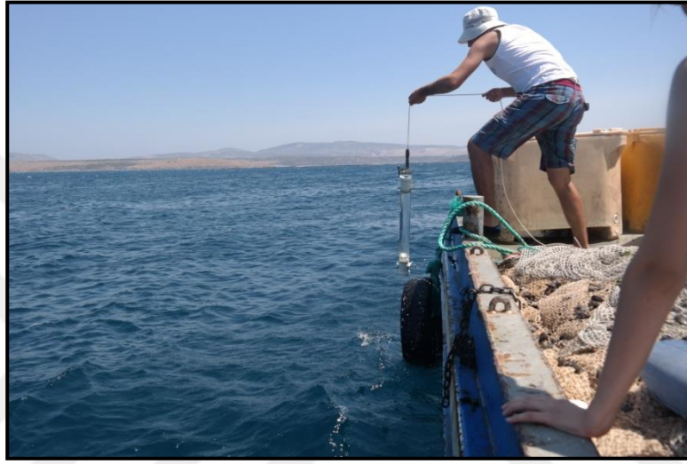
Şekil 2.3.1: Su örnekleyicisi ile su numunelerinin alınması (Orijinal).
