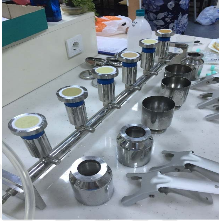
Şekil 2.4.3: Manifold kullanılarak gerçekleştirilen süzme işlemi (Orijinal).
