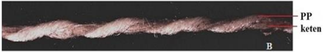
Şekil 6.6: Keten / polipropilen lif (Karaca, 2017).
