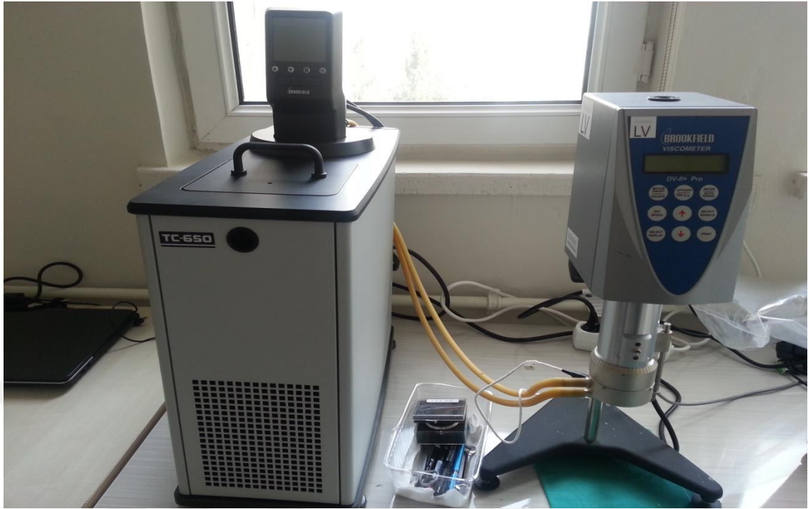
Şekil 3.3. Tam kan ve Plazma Vizkosite Ölçümü İçin Kullanılan Viskozimetre
