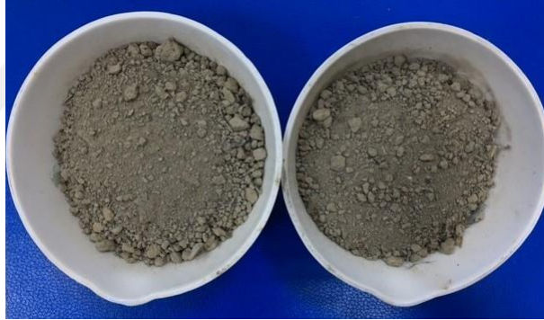
Şekil 4.1 : Organik madde tayini deney numuneleri.
