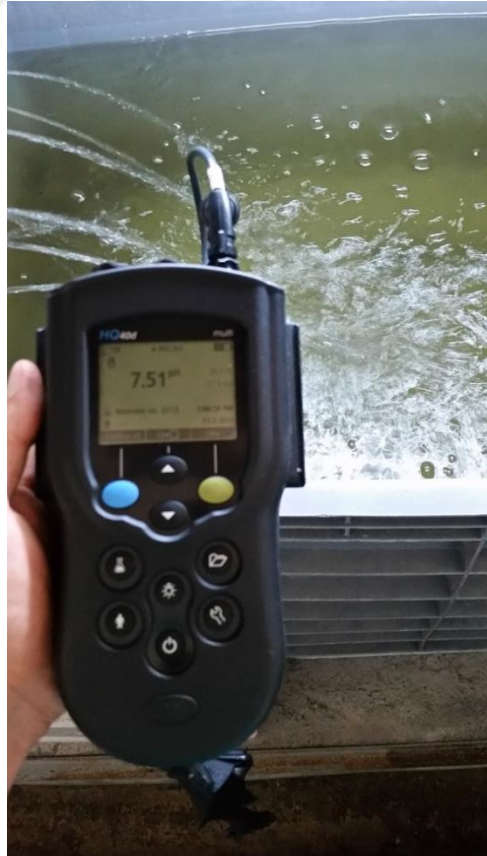
Ek 6: Deneme Tanklarında Su Parametrelerinin Ölçümü ve Kullanılan Cihaz.
