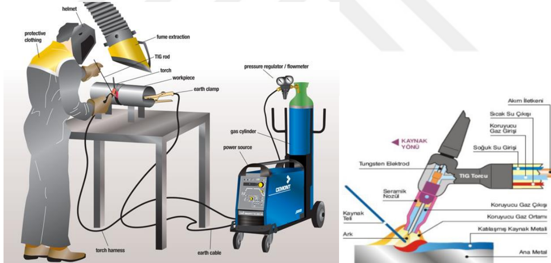
Şekil 1.13: TIG Kaynak makine ve torç şematik gösterimi
