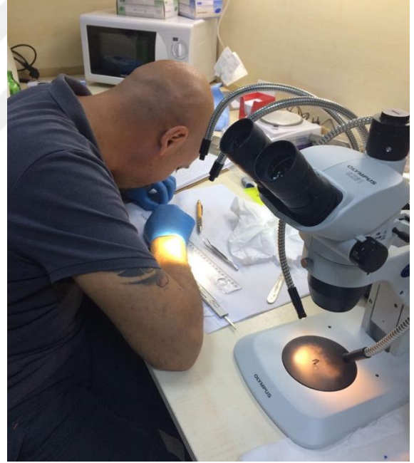
Şekil 15. Morfolojik incelemelerde kullanılan dijital kumpas ve stereo mikroskop.
