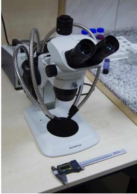
Şekil 15. Morfolojik incelemelerde kullanılan dijital kumpas ve stereo mikroskop.
