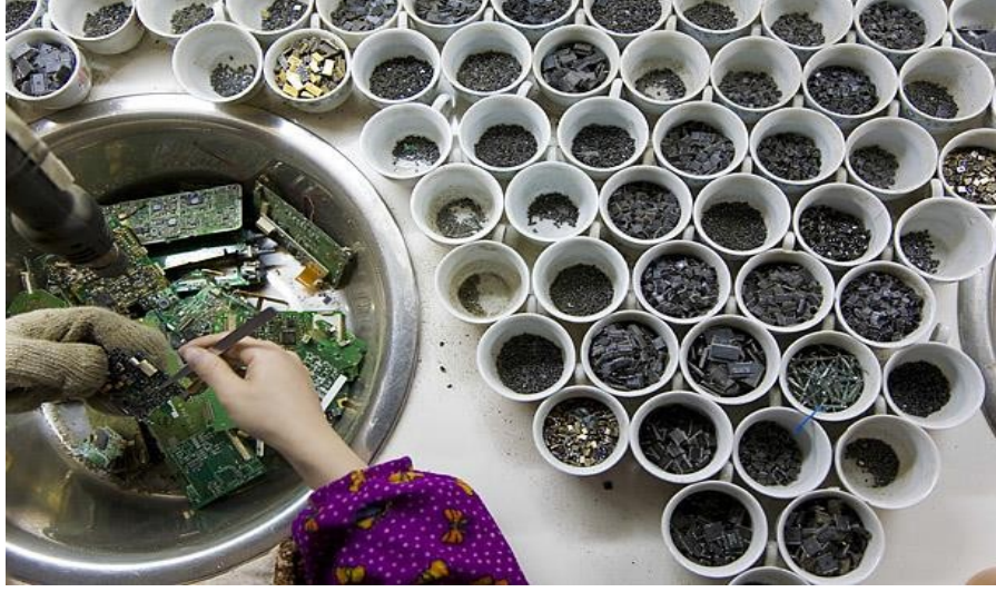
Şekil 1.8: E-atıkların el ile mekanik olarak ayrılması esnasında ayrılan metal, plastik ve çipler [16].
