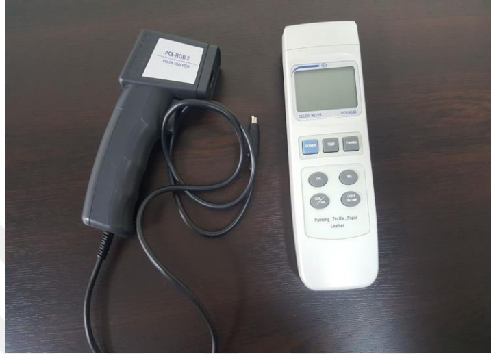
Şekil 3.12. Denemede Kullanılan Renk Ölçer (PCE-RGB Renk Ölçer (DIN 5033); Orijinal).
