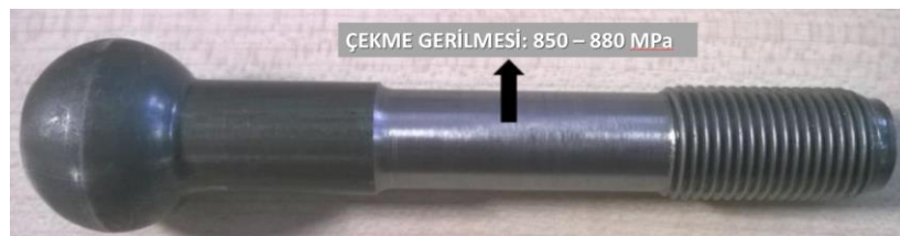
Şekil 5.24 : Rotmili şaft bölgesi çekme test numunesi
