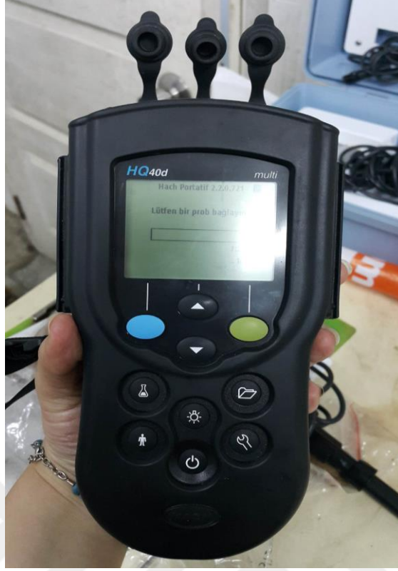
Şekil 3. 6: Kullanılan Su Parametresi Ölçüm Cihazı (Orijinal).
