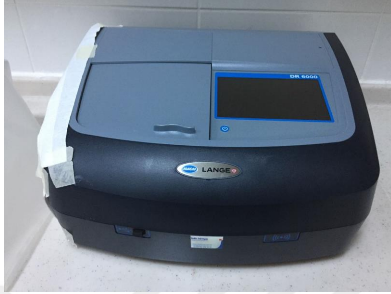
Şekil 3. 8: Analizler İçin Kullanılan Spektrofotometre Cihazı (Orijinal).
