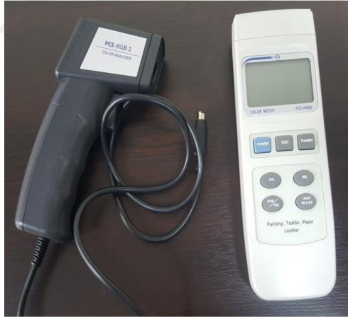
Şekil 3. 14: Denemede Kullanılan Renk Ölçer (PCE-RGB Renk Ölçer (DIN 5033); Orijinal).
