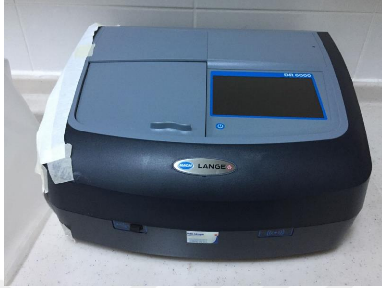
Şekil 3. 8: Analizler İçin Kullanılan Spektrofotometre Cihazı (Orijinal).
