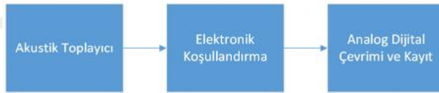
Şekil 2. Çalışmada gastrointestinal aktiviteye ait seslerin kaydedilebilmesi için kullanılan elektronik enstrümanın blok diyagramı
