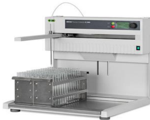
Şekil 3.2. Ters Faz RP-18 kolon kromatografisinde kullanılan Buchi C660 fraksiyon ayıcı ve toplayıcı.
