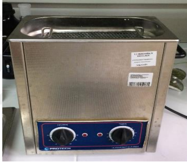
Şekil 3.5: Ultrasonik su banyosu.
