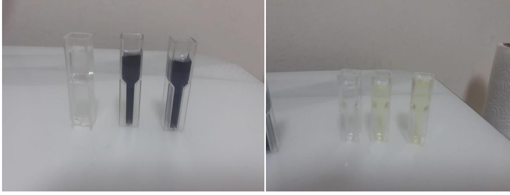
Şekil 4.4: Antioksidan madde analizleri. (A: DPPH reaktifi stok çözeltisinin analiz öncesi rengi. B:30 dakika sonundaki DPPH reaktifinin renk değişimi).
