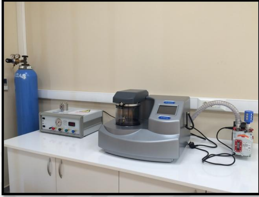
Şekil 3.13: QUORUM Q150 RES kaplama cihazı / İzmir Katip Çelebi Üniversitesi Merkezi Araştırma Laboratuvarı ( http://merkeziarastirmalab.ikc.edu.tr/S/15260/sem ).
