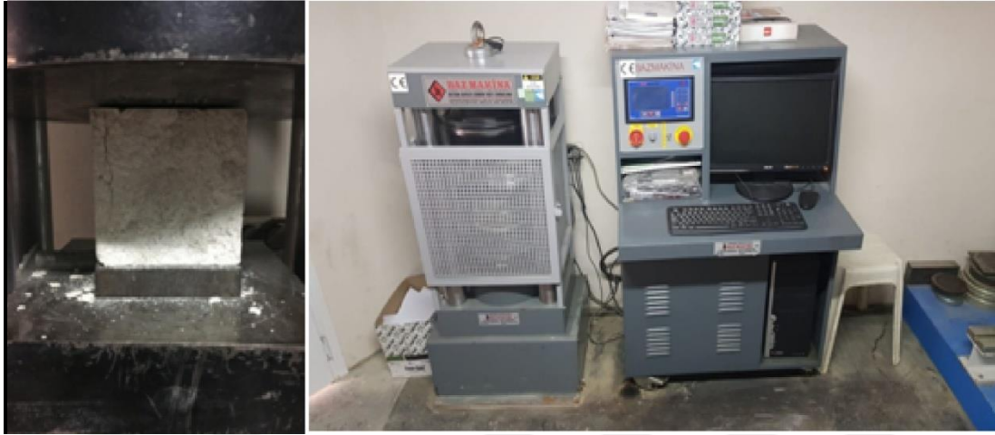
Şekil 3.8 : Otomatik pres ve küp numune basınç kırılması.
