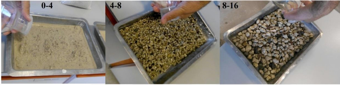
Şekil 3.1 : Üç farklı tane boyut aralığındaki agregaların görünümü.
