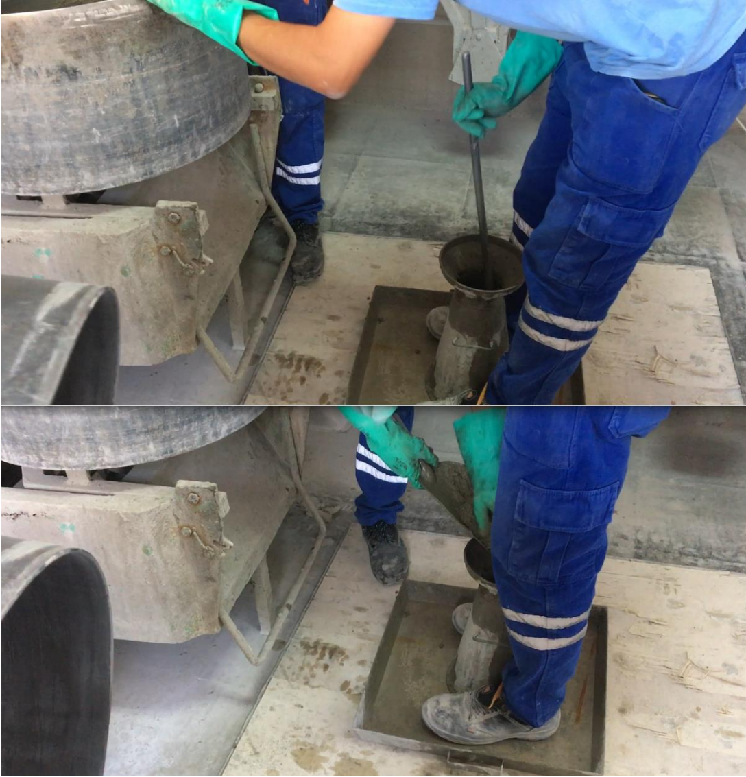
Şekil 3.6 : Slump (çökme) hunisine betonun yerleştirilme ve doldurulma aşamaları.
