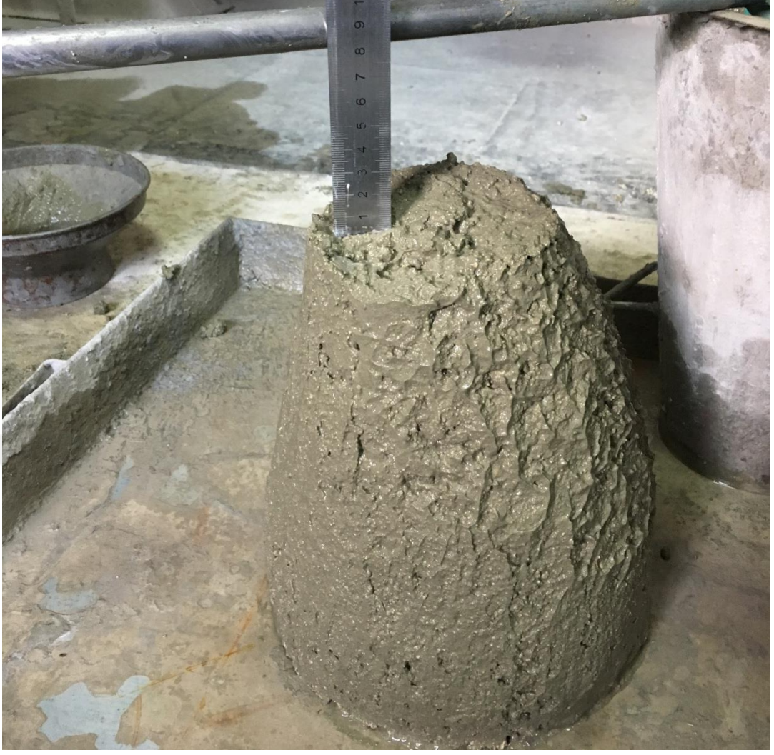
Şekil 3.7 : Çökme değerinin ölçülmesi.
