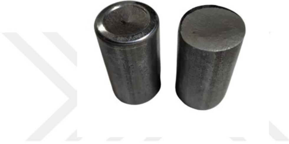
Şekil 2.4 Taban düzeltmeyi gösteren istasyon numuneleri.
