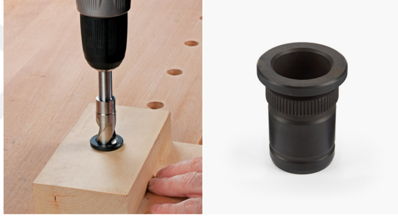
Şekil 1.1 Ahşap malzemede yataklama burcu uygulaması [1]
