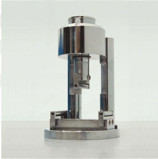
Şekil 3.8: Üç noktalı eğilme dayanımı aparatı [47]
