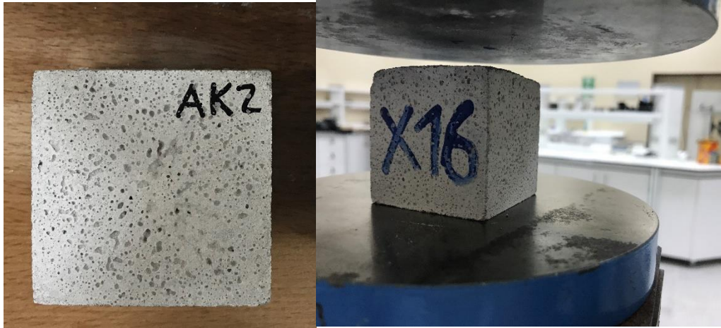
Şekil 3.7: Basınç dayanımı testi için 50x50x50 mm boyutlu numuneler.
