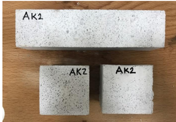
Şekil 3.5: Kalıplardan çıkarılan numuneler.
