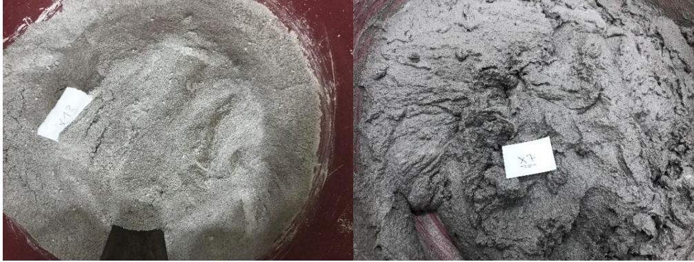
Şekil 3.3: Kuru karışım ve su ile karıştırıldıktan sonraki hali.
