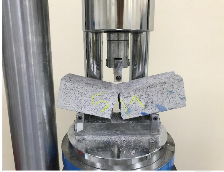
Şekil 3.9: 40x40x160 mm prizmatik eğilme dayanımı testi sonrası numune.
