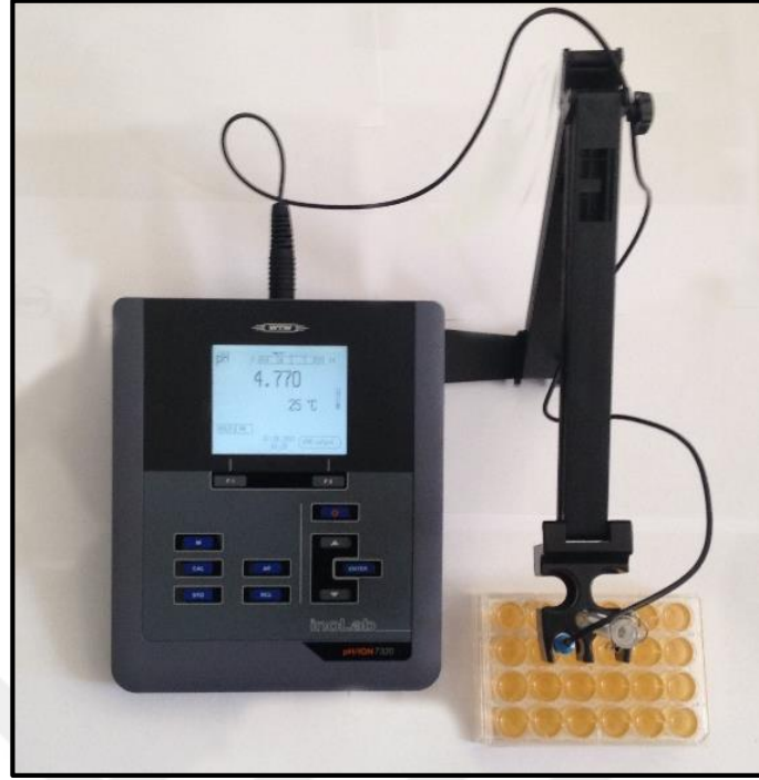
Şekil 25: pH metre ve mikroelektrot aracılığıyla örneklerin pH değerlerinin ölçülmesi
