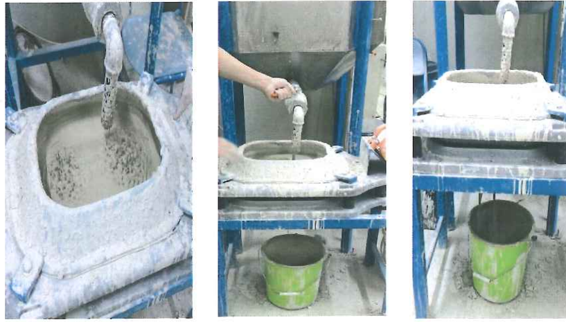
Fot. 26: Döküm kilinin karıştırılarak süzülmesi
