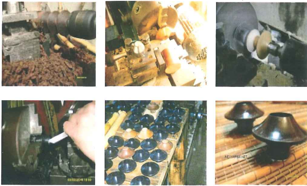
Fot. 20: Başpare yapım aşamaları
