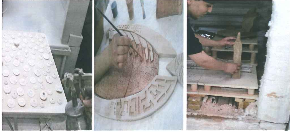
Fot. 35: Kompresör-Fırça İle Renklendirme ve fırına yerleştirilmesi
