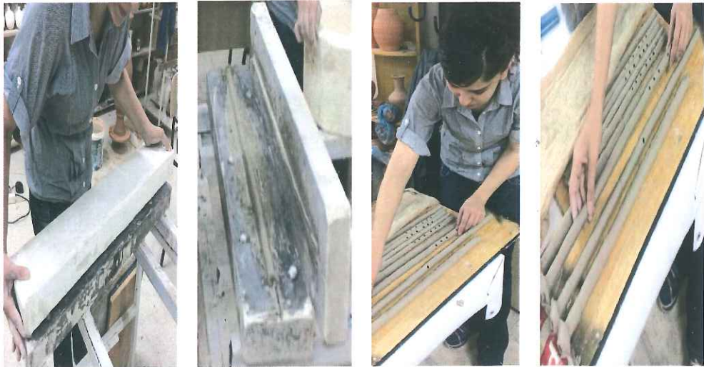
Fot. 28: Dökümün kalıptan çıkartılıp kurutulmaya bırakılması
