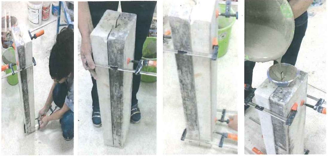
Fot. 27: Kalıbın işkence ile sıkıştırılarak dökümün yapılması
