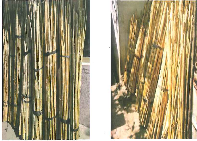
Fot. 7: Kamışların bağlanıp kurutulmaya bırakılması
