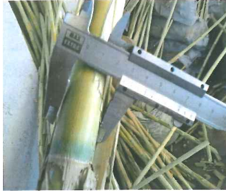
Fot. 8: Kamışın kalınlığının hesaplanması
