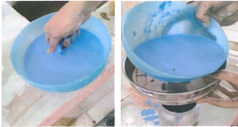
Fot. 33: Öğütülen sırların elekten geçirilmesi
