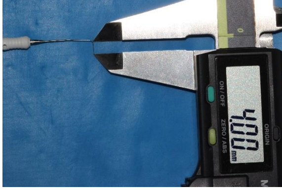
Resim 6: #15 el spreader'ın ucunun 4 mm'den kıvrılması
