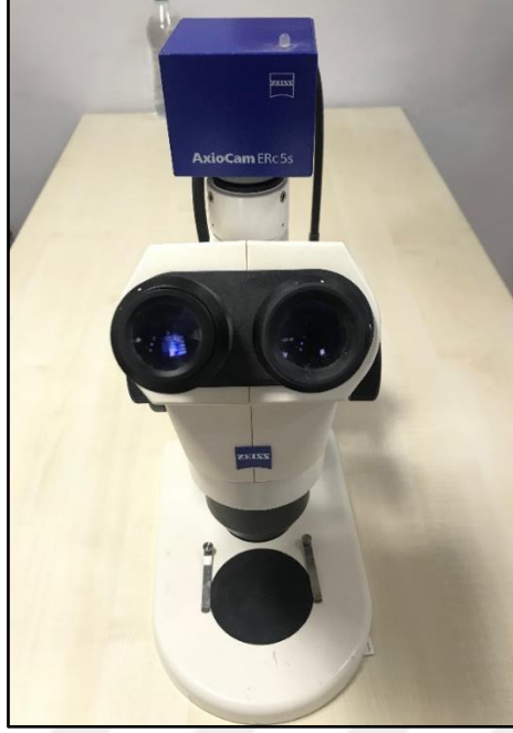
Resim 21 Kopma yüzeylerinin incelenmesinde kullanılan stereomikroskop
