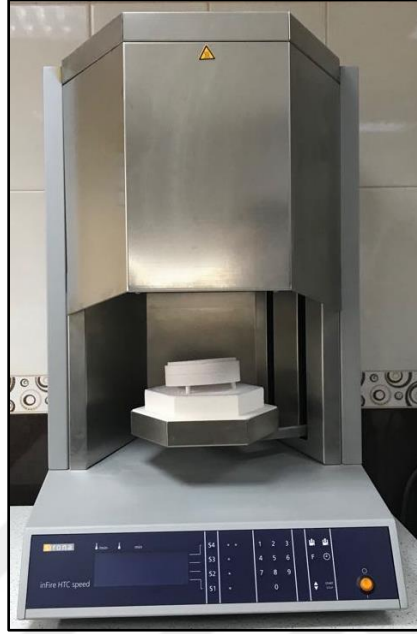
Resim 4 Sirona inCoris HTC speed sinterleme fırını
