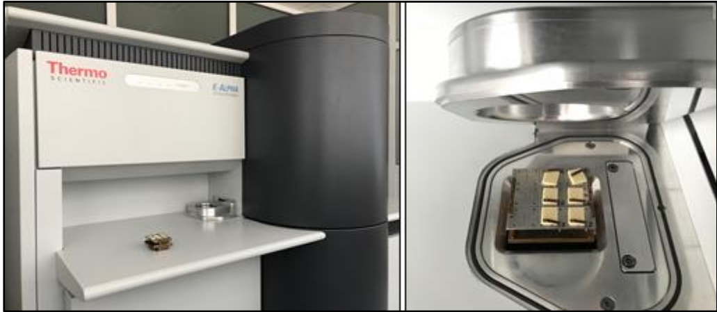
Resim 22 XPS cihazı ve örneklerin analiz için cihaza yerleştirilmesi
