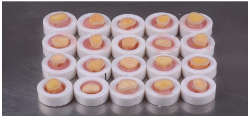
Şekil IV: Dentin yüzeyi açığa çıkarılmış ve zımparalanmış örnekler
