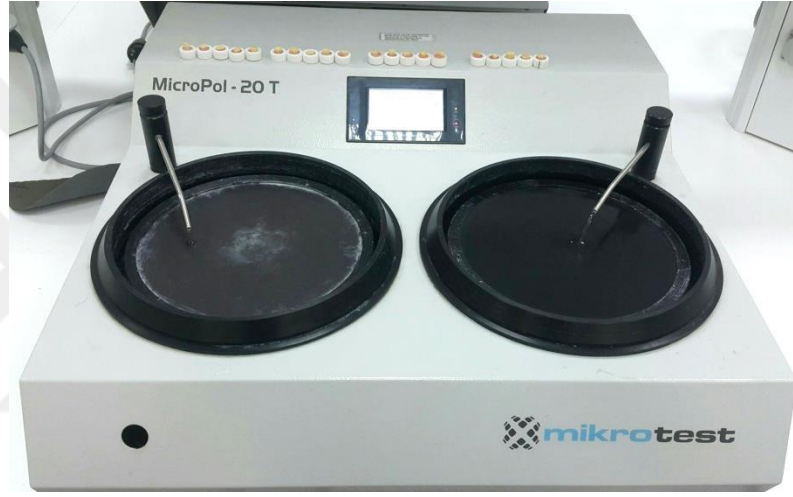
Şekil III: Polisaj makinesi ile örneklerin zımparalanması
