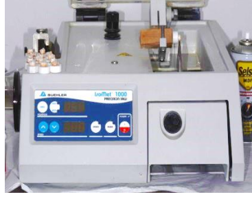
Şekil II: Elmas diskli kesme cihazı ile dentin yüzeylerinin açığa çıkarılması
