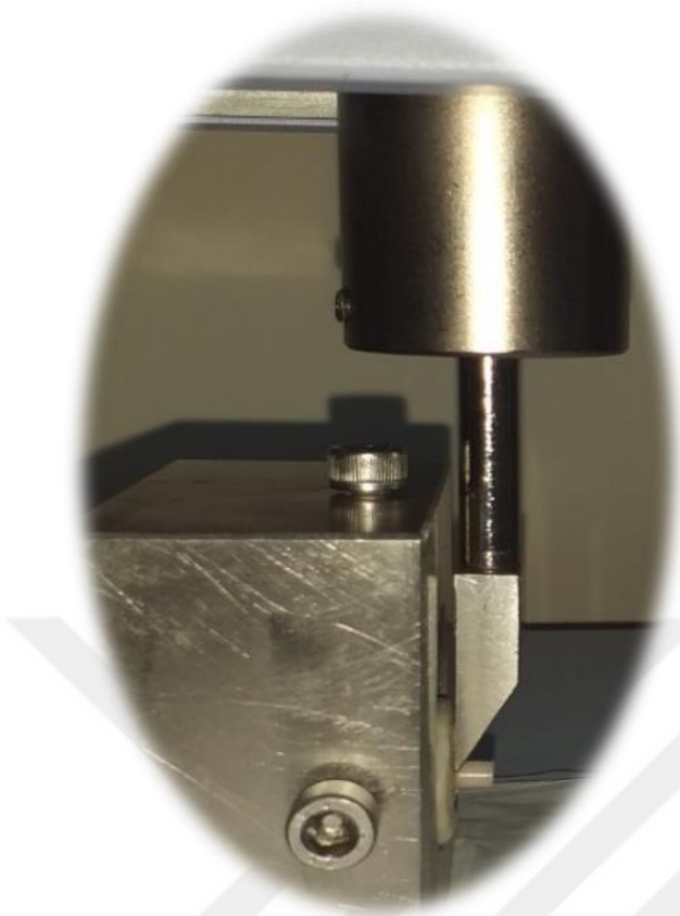
Resim 6: Örneklerin üniversal test cihazına yerleştirilmesi
