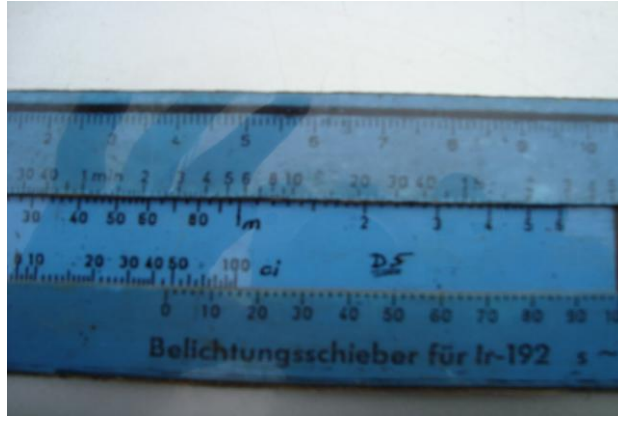
Şekil 7.24. Poz süresinin tespiti için kullanılan hazır cetvelin yakın görünümü.
