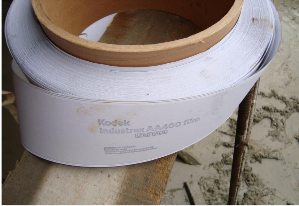
Şekil 7.11. Radyografik çekim için kullanılan film.
