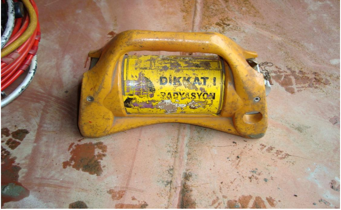
Şekil 7.2. Bu Tez Kapsamında Kullanılan Ir-192 Gamagrafi Cihazının Görüntüsü
