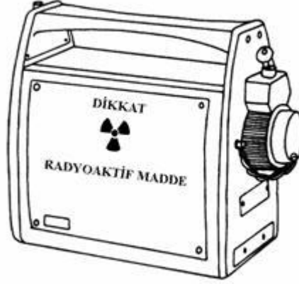
Şekil 4.6. Projeksiyon tip ışınlama cihazı.
