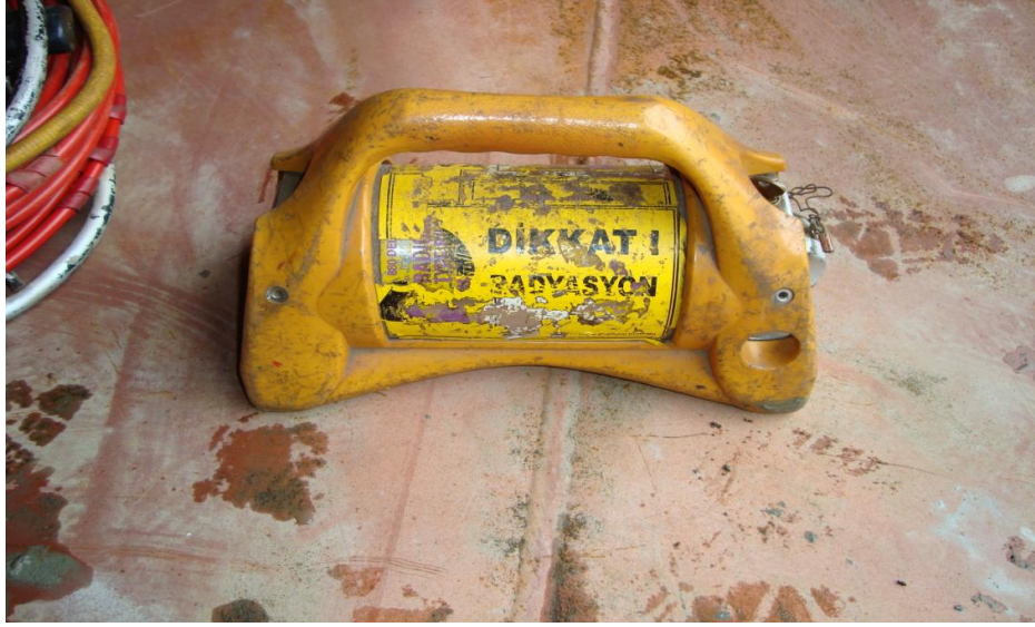
Şekil 7.7. Ir-192 Radyoizotopunun Zırh Kabı.
