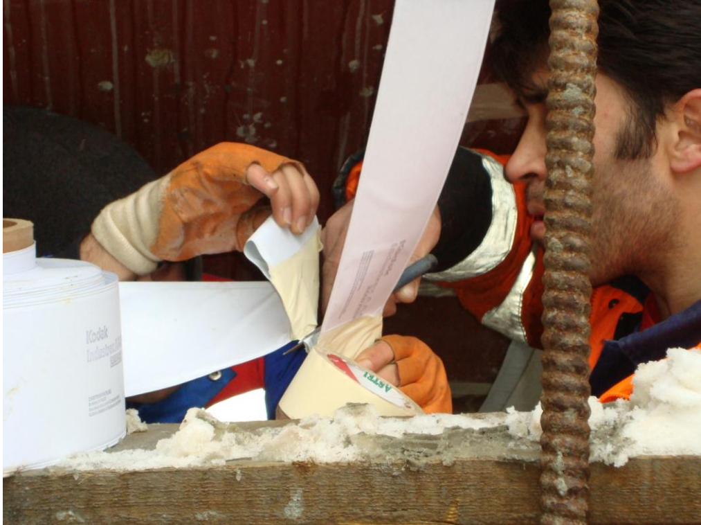
Şekil 7.12. Radyografik çekim için kullanılan filmin hazırlanması.
