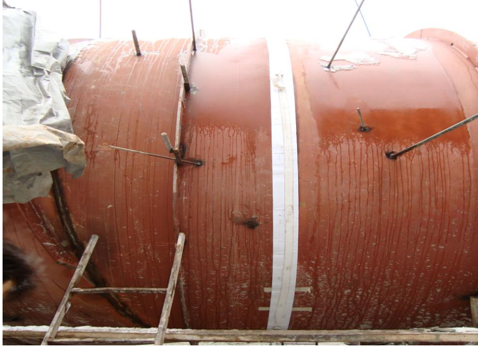
Şekil 7.15. Radyografik çekim için hazırlanmış çelik borunun dıştan görünümü.
