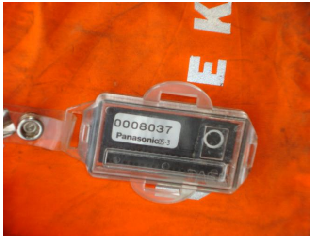
Şekil 7.25. Kullanılan kişisel dozimetre.
