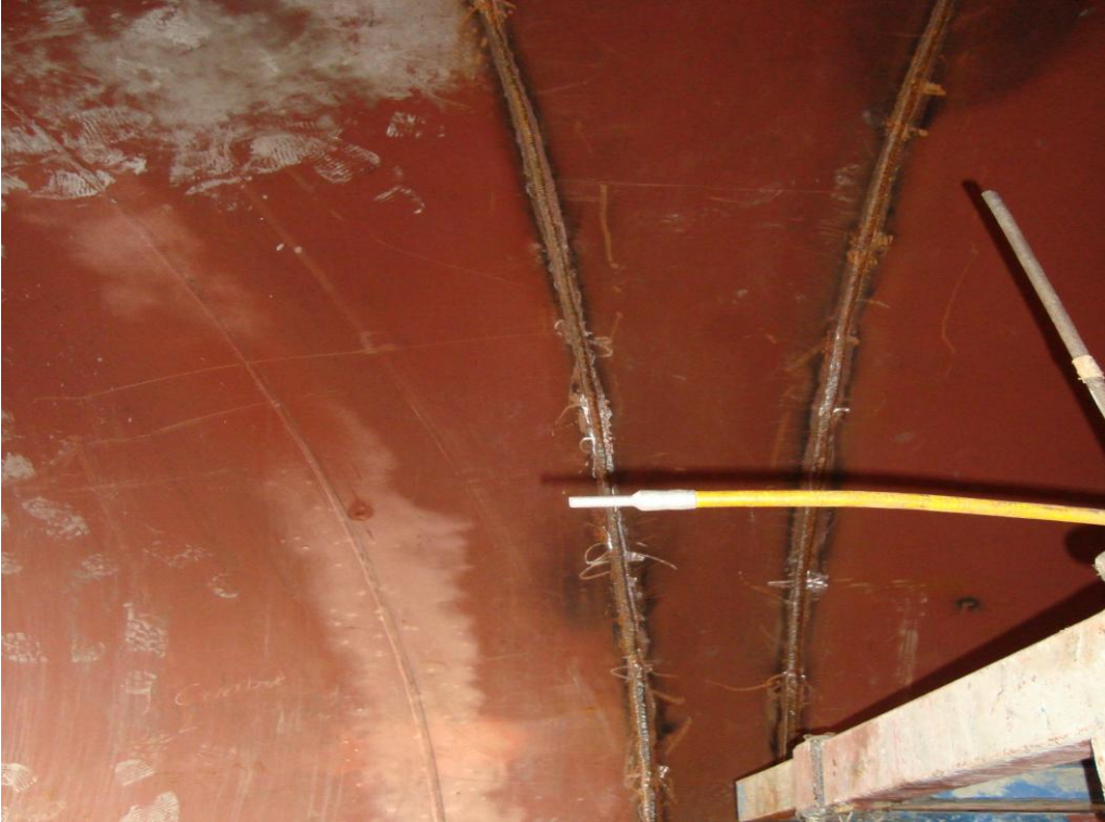
Şekil 7.22. Işınlama başının kaynak bölgesinin tam merkezine yerleştirilmesi.
