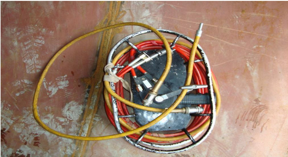
Şekil 7.6. Ir-192 Radyoizotopunun kumanda kablosu ve ışınlama ucu.
