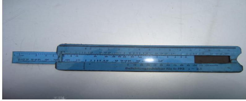
Şekil 7.23. Poz süresinin tespiti için kullanılan hazır cetvel.
