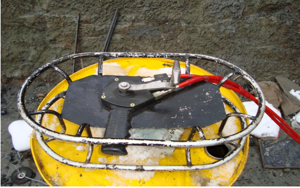
Şekil 7.5. Ir-192 Radyoizotopunun Kumanda Mekanizması.
