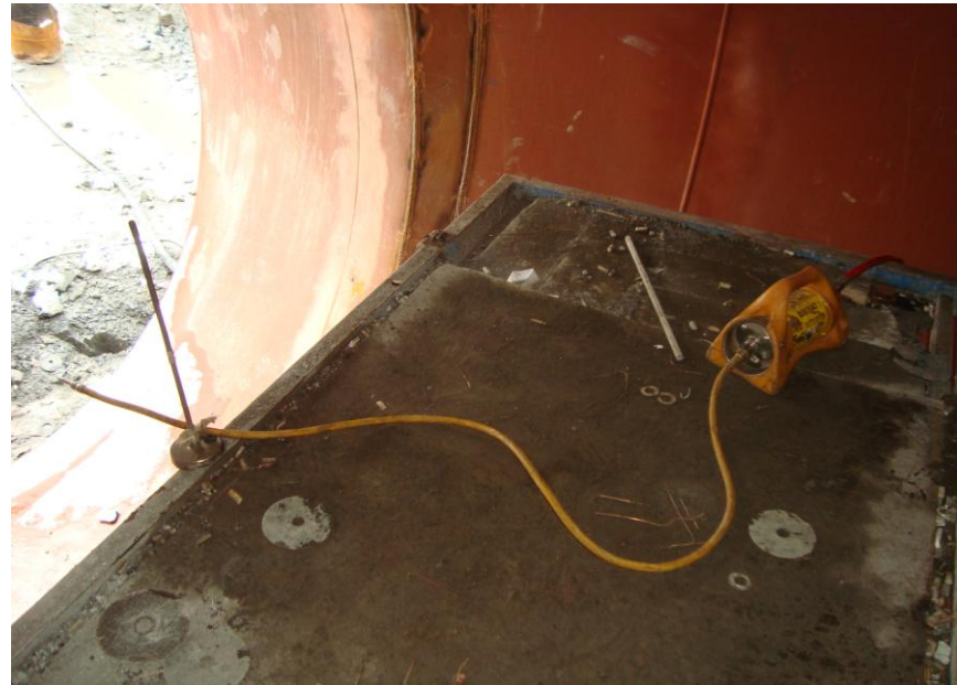
Şekil 7.20. Merkezden ışınlama yapmak için hazırlanmış platform.
