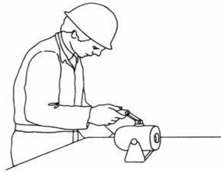
Şekil 4.4. Radyografi Personeli Kapaklı Tip Işınlama Cihazının Kendi Zırhlamasından Yararlanır [8].
