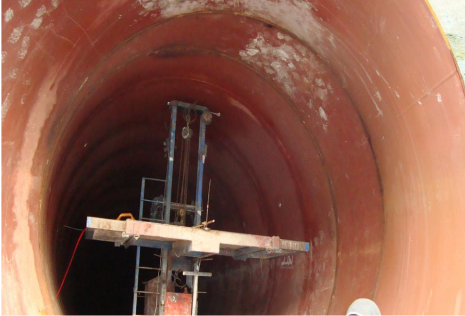
Şekil 7.18. Çelik borunun merkezine radyoizotopun yerleştirilmesi.
