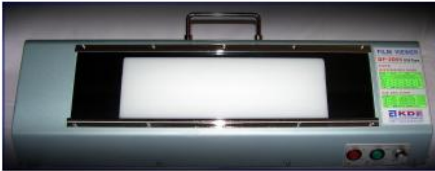
Şekil 7.28. Radyografik filmleri aydınlatmakta kullanılan ışık kaynağı.
