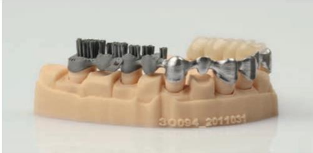
Şekil 3.4. DMLS ile üretilmiş metal altyapı
