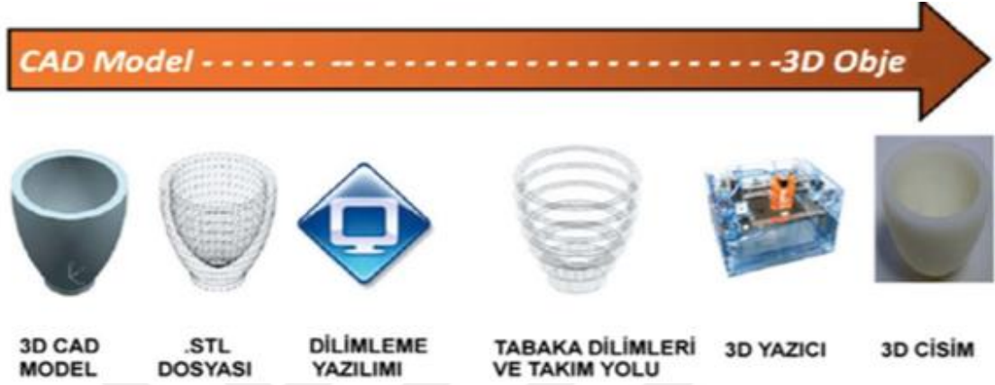
Şekil 2.2. Genelleştirilmiş Katmanlı Üretim Prosesi 40
