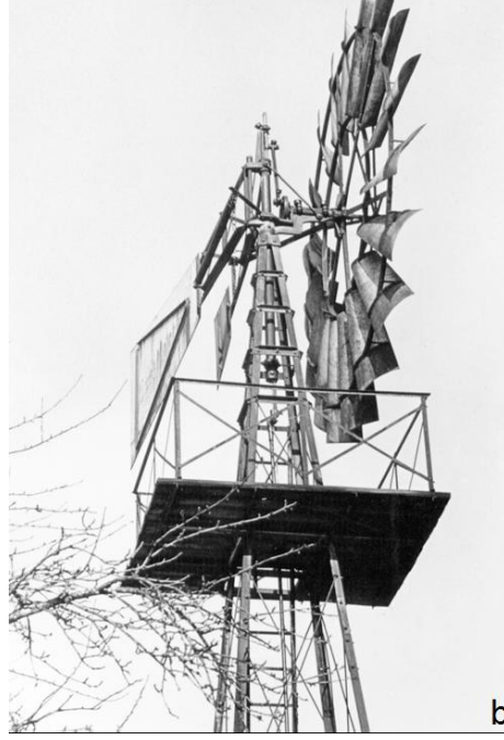
Şekil 1.5 : a-Klasik yel değirmeni(Hau, 2006); b-Yavaş rüzgar türbini (Hau, 2006)
