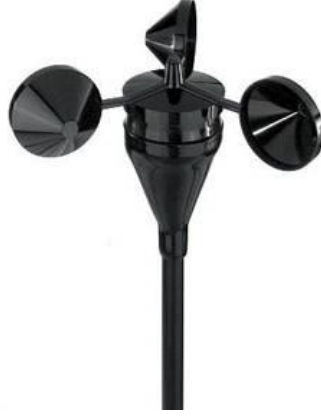
Şekil 3.1 : Kepçe anemometre (Manwell ve diğ., 2002)
