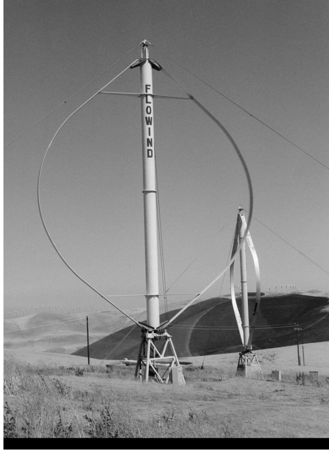
Şekil 1.4 : Amerika Flowind şirketinin Darrieus rüzgar türbini (Rotor çapı 19 m, anma gücü 170 kW) (Hau,2006)
