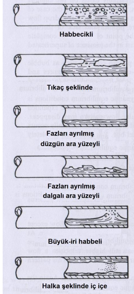
Şekil 4.5 : Yatay akışta iki-fazlı akış rejimleri (Collier ve Thome, 1996).
