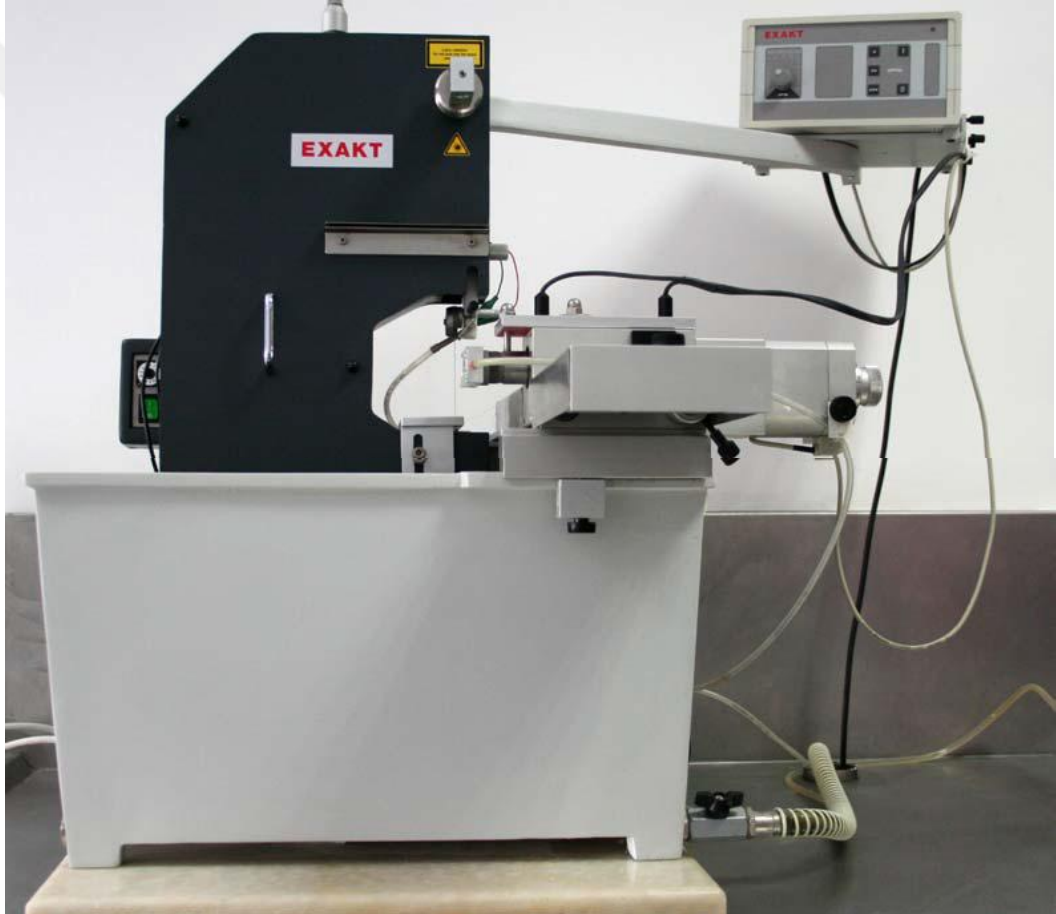
Şekil 3.18: Exakt 300 CP Hassas kesme ünitesi
