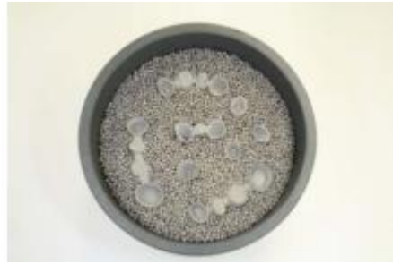
Şekil 2.2 InCoris CC için sinterleme tepsisi ve boncukları (42)
