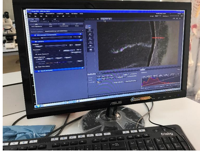
Şekil 3. 13. Zen lite 2011 programıyla yapılan marjinal aralık ölçümü
