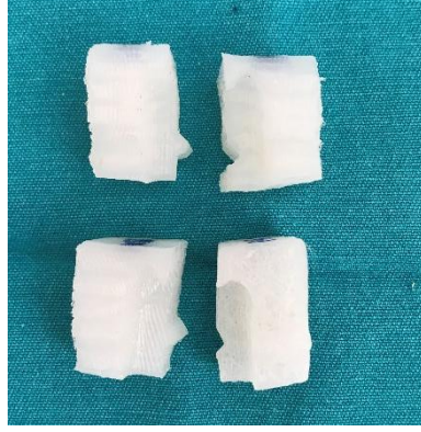
Şekil 3. 8. Silikon rehberin 3D yazıcıda oluşturulan naylon kopyası
