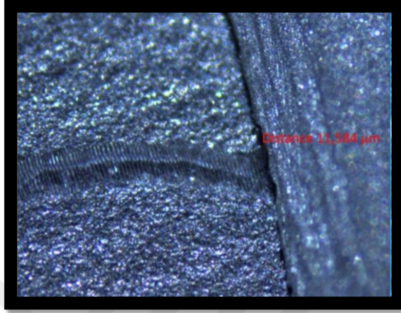
Şekil3.15. Işık mikroskobunda lazer sinterize metal altyapının 4x büyütülmüş görüntüsü
