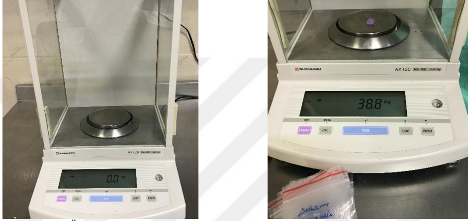
Şekil 3. 17. Ölçümlerin yapıldığı hassas terazi ve silikon replikanın ağırlığının ölçümü
