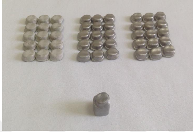
Şekil 3. 5. Sol taraftan itibaren sırasıyla 15 adet yumuşak metal, 15 adet döküm ve 15 adet lazer sinterize altyapı.
