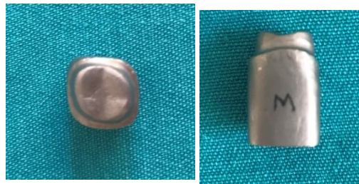
Şekil 3. 4. Lazer sinterizasyon yöntemiyle oluşturulan metal güdük
