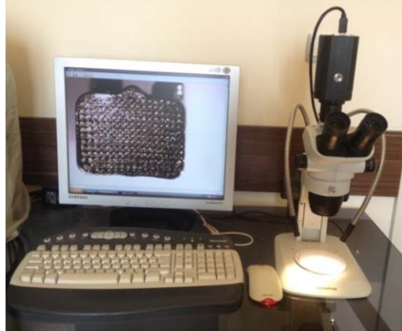
Şekil 10. Braket tabanlarının görüntülenmesinde kullanılan Olympus marka SZ61 model stereomikroskop
