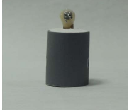
Şekil 1. Plastik borulara alçı doldurularak gömülen ve braketini yapıştırılan diş örneği
