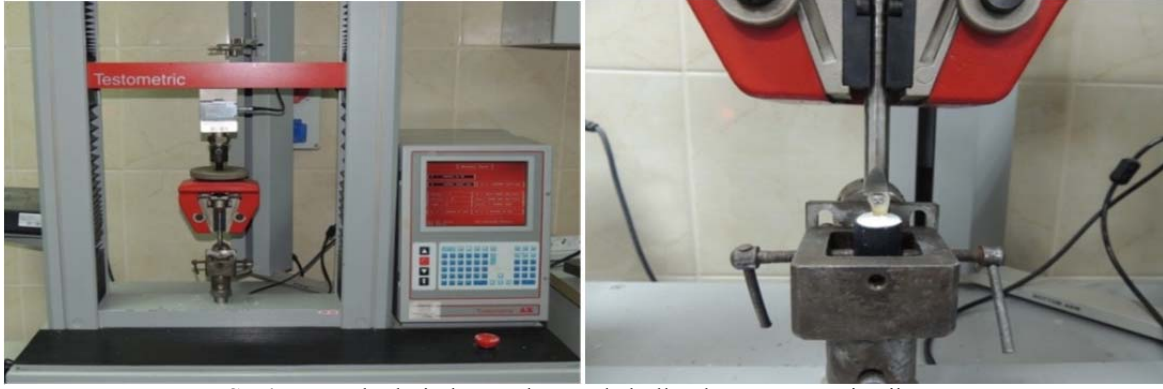
Şekil 7. Braketlerin kopartılmasında kullanılan Testometric cihazı
