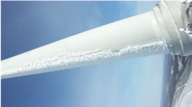
řekil 6.19: Kanatta buzlanma sonucu oluřan sarkıklar.
