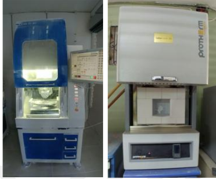
(a) (b) Şekil 3.1. Zirkonya kazıma cihazı(a), zirkonya sinter fırını(b)
