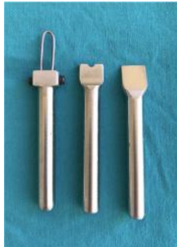
Şekil 3.9.Çalışmada kullanılan bıçak tasarımları; tel ilmek uç, çentikli çubuk uç, bıçak sırtı keski
