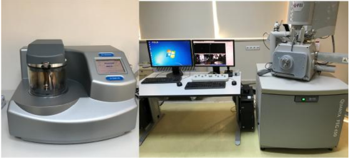
(a) (b) Şekil 3.11. Altın kaplama cihazı(a), taramalı elektron mikroskobu(b)
