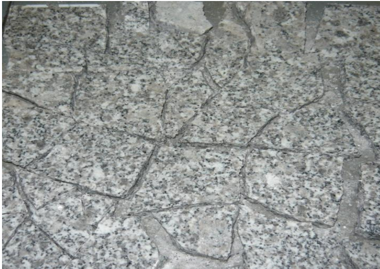
Şekil 4.2 : Balyoz yardımıyla kırılan örnekler
