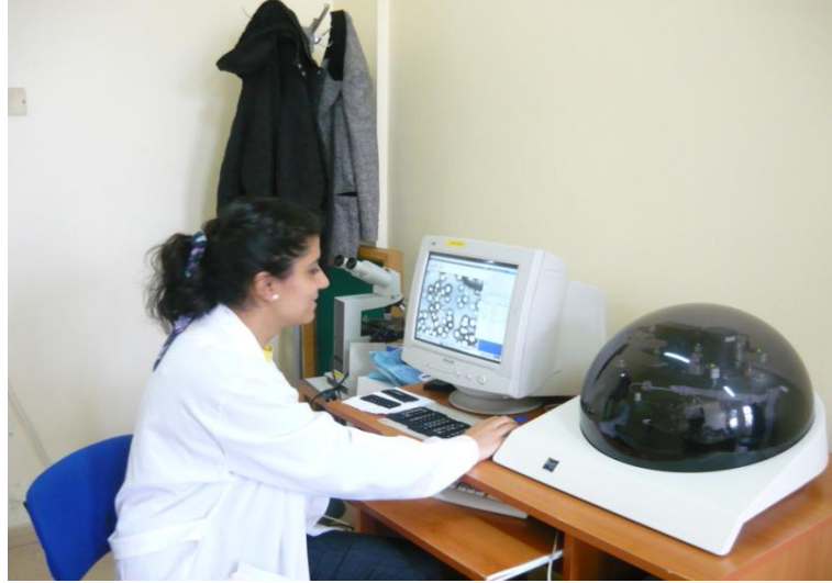
Şekil 4.22 : Detektörler üzerinde meydana gelen alfa izlerinin sayım işlemi
