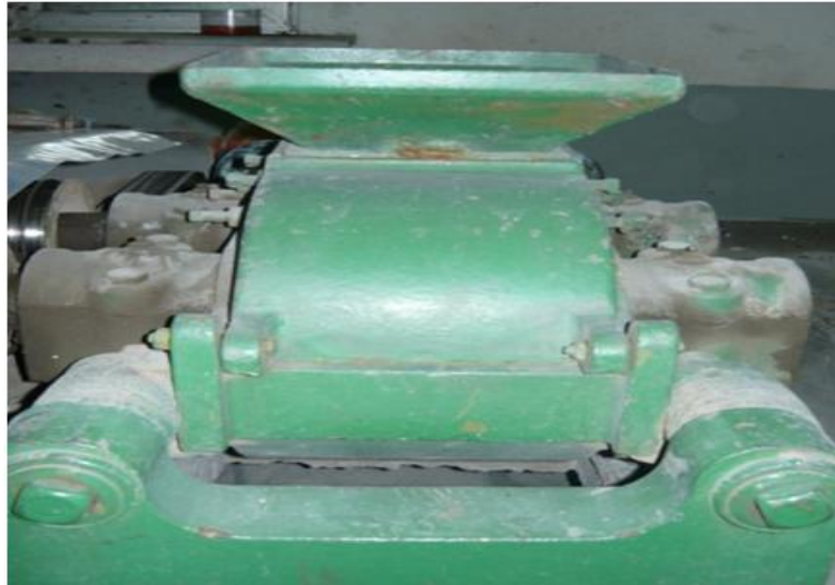
Şekil 4.4 : İTÜ Maden Fakültesi Cevher Hazırlama Pilot Tesisi'nde bulunan Merdaneli Kırıcı.
