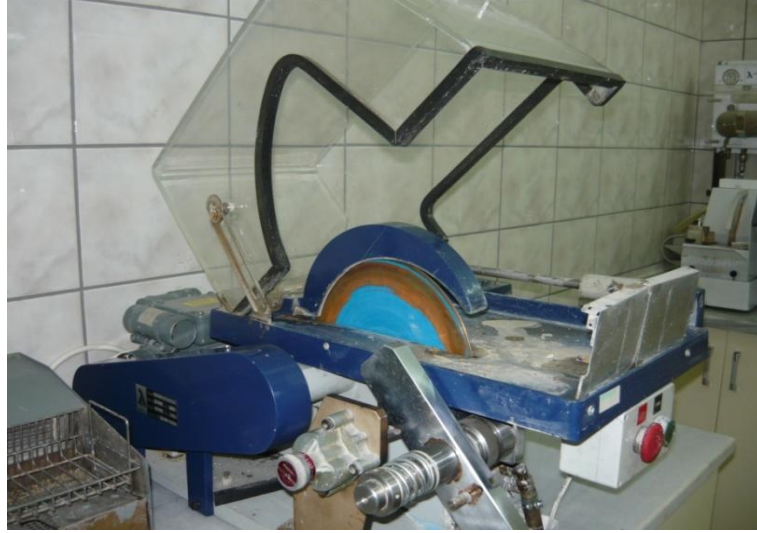
Şekil 4.6 : İTÜ Maden Fakültesi İnce Kesit Hazırlama Atölyesi'nde bulunan kesici çark
