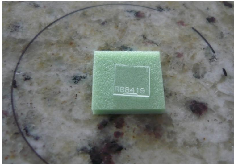
Şekil 4.11 : Diyafram malzeme ve üzerine yerleştirilen CR-39 detektörü.
