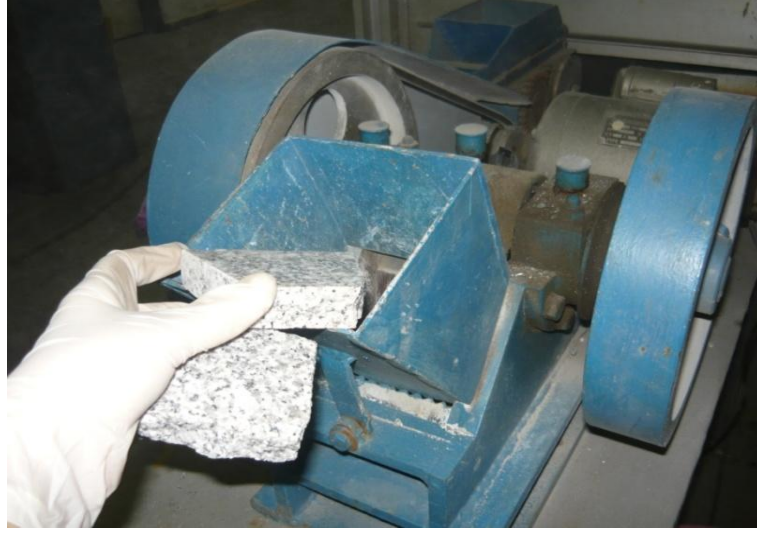
Şekil 4.3 : İTÜ Maden Fakültesi Cevher Hazırlama Pilot Tesisi'nde bulunan Çeneli Kırıcı.
