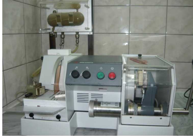
Şekil 4.7 : İTÜ Maden Fakültesi İnce Kesit Hazırlama Atölyesi'nde bulunan ince kesit makinesi
