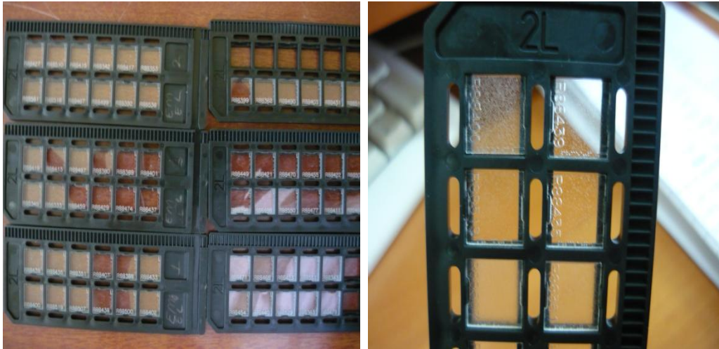
Şekil 4.18 : Radoslide detektör tutucu’ya yerleştirilmiş detektörler
