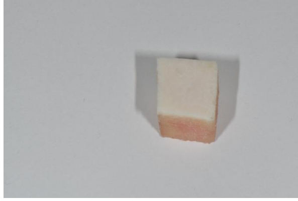
Şekil 3.1. Sığır kalça kemiğinden elde edilen kemik modelinin üstten görünümü
