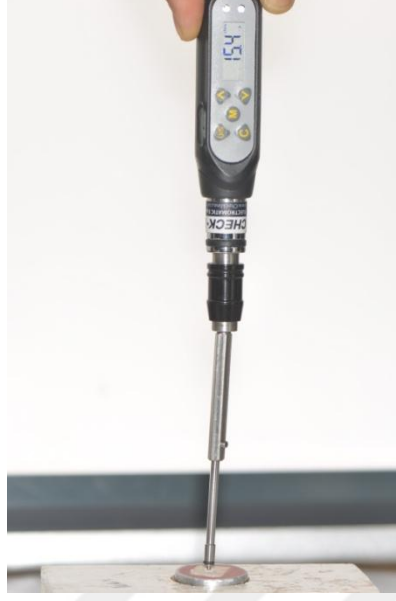
Şekil 3.19. Maksimum yerleştirme torkunun ölçülmesi (90° yerleştirme açısı)
