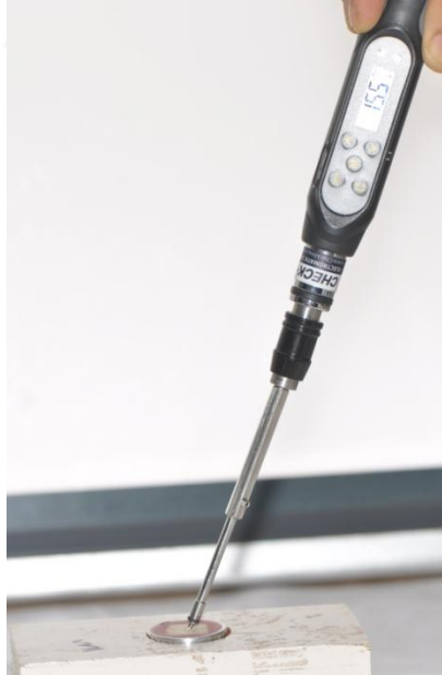
Şekil 3.18. Maksimum yerleştirme torkunun ölçülmesi (60° yerleştirme açısı)
