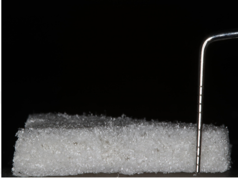
Şekil 3.1. Sünger formunda 3 boyutlu greft materyali
