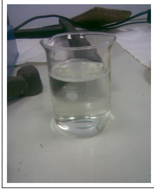
Şekil 7.11 : Oda koşullarında yaşlandırılan Al-polihidroksi çözeltisi.
