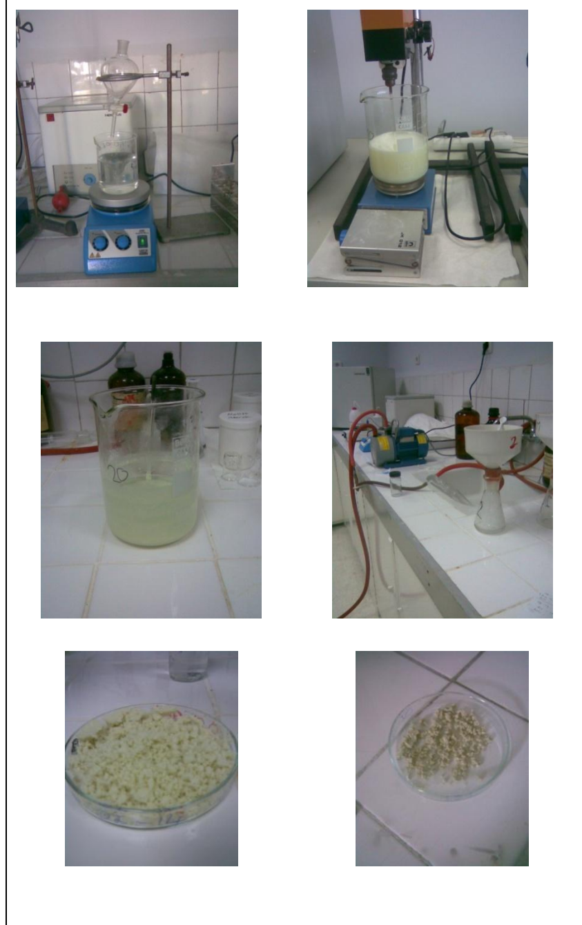
Şekil 7.12 : Organo-inorgano-bentonit üretimi aşamaları.
