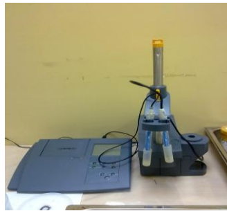
Şekil 7.13 : pH/sıcaklık kombine elektrodu ve kombine ORP.
