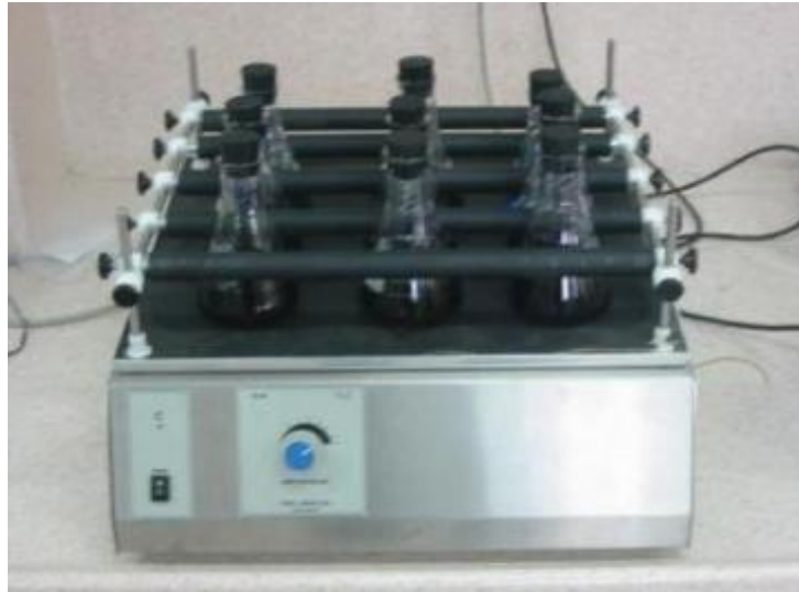
Şekil 6.16 : Kesikli adsorpsiyon yöntemi düzeneği, (Balcı, 2007).
