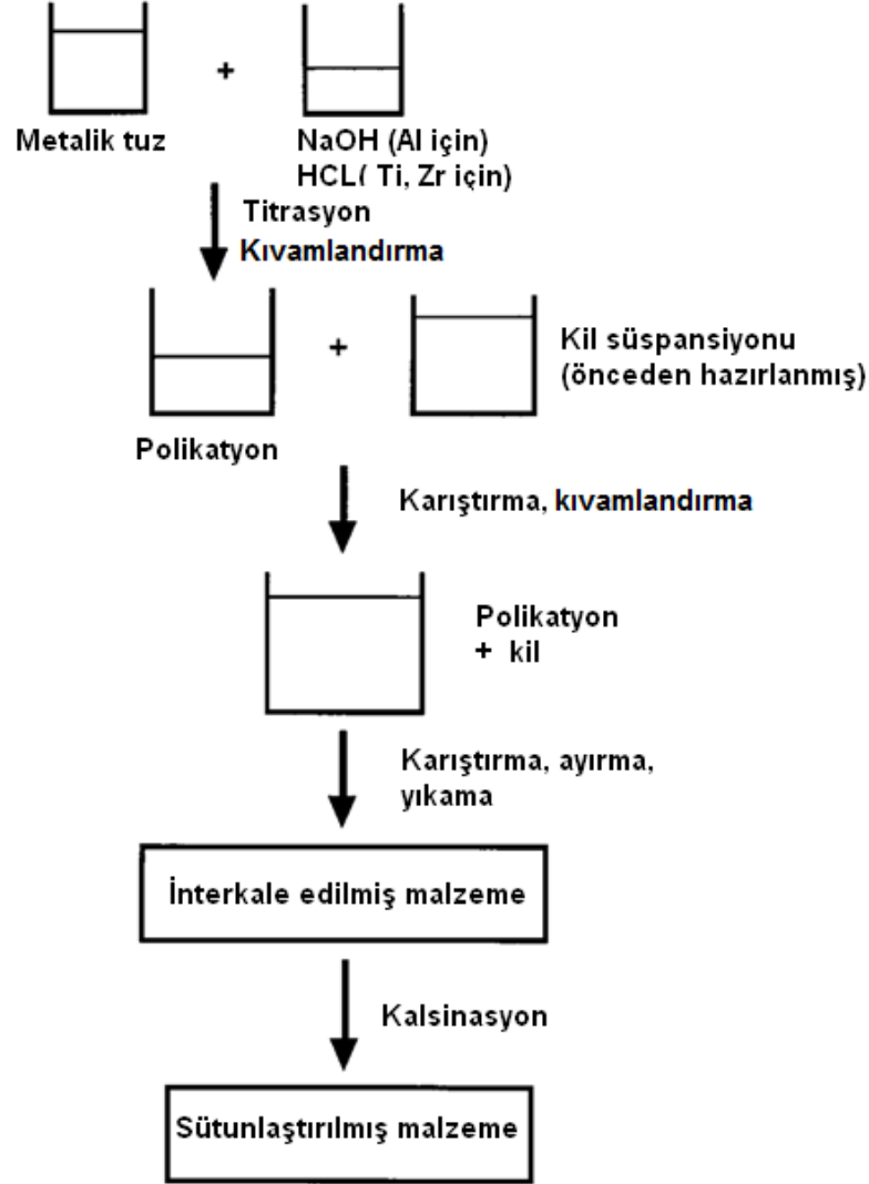
Şekil 5.10 : Sütunlaştırılmış kil üretimi, Gil ve diğ. (2000) den uyarlanmıştır.
