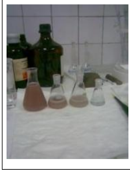
Şekil 7.9 : Süzüntülerde Cl- tespiti için yapılan \text{AgNO}_3 testi.
