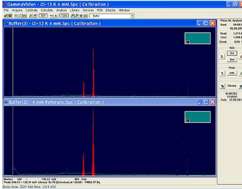
Şekil G.1 : DSROL sisteminde 4mM konsantrasyon için OI-13 ile gerçekleştirilen adsorpsiyon öncesi ve sonrası 75 Se radyoizotopu spektrumlarının karşılaştırıldığı .spc uzantılı spektrum dosyası görüntüleri.
