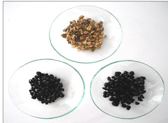
Şekil 6.1 Hammadde olarak kullanılan zeytin çekirdekleri (üst), aktif karbon (sol alt) ve impregne edilmiş karbon (sağ alt).
