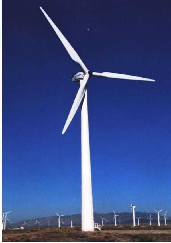
Şekil 2.8 : Üç kanatlı rüzgar türbini (Goldwind S48/750) Almanya (URL-2).
