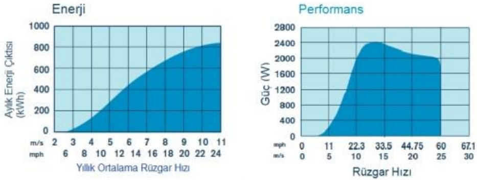
Şekil 4.4 : İTÜ RT-1'in üretici tarafından verilen enerji ve performans grafikleri.
