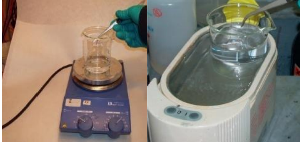
Şekil 5.2: ITO kaplı camın ultrasonik banyoda temizlenme prosesi (Krebs, 2008)
