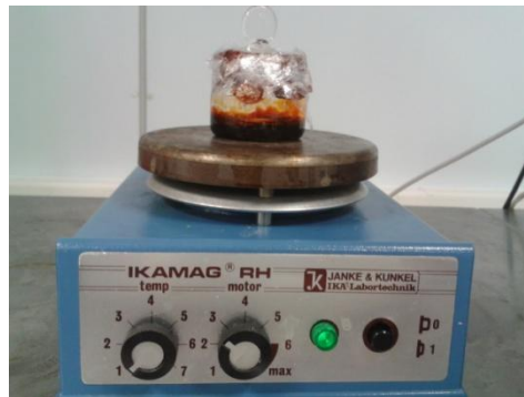
Şekil 5.3: Aktif Tabakanın Magnetik Karıştırıcıda Çözünmesi
