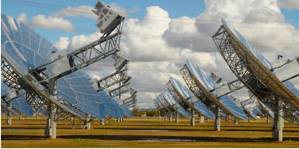
Şekil 1.10: Parabolik çanak tipi güneş enerjisi sistemi [12].
