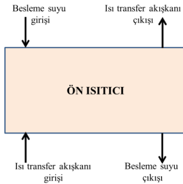
Şekil 2.10: Bir ön ısıtıcının şematik gösterimi.
